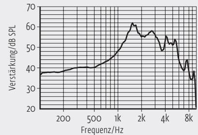
Die Kurven wurden mit einem 2cm<sup>3</sup>-Kuppler (EN 60318-5:2006) gemäß EN 60118-7:2005 in Messeinstellung ermittelt.
